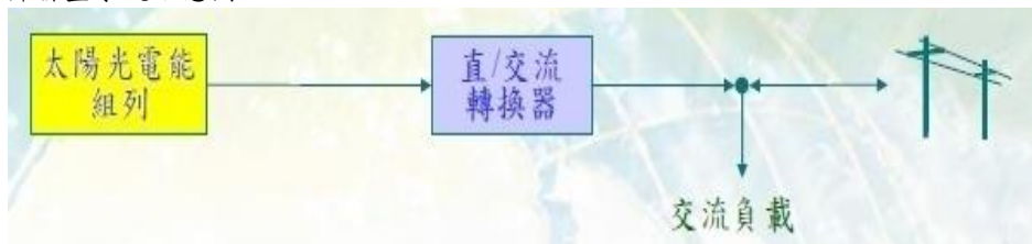
併聯型系統示意圖
